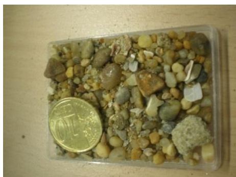
Illustration 26 : Exemple de matériau grossier prélevé lors du dragage du chenal de Fromentine
