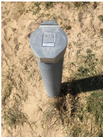
Illustration 12 : Nouveau tubage et capot de protection de PG1
